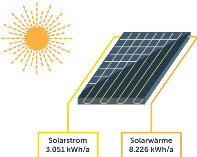
Der in Bochum verwendete Kollektortyp erzeugt aus Solarstrahlung sowohl Strom als auch Wärme und wird daher PVT-Kollektor oder Hybridkollektor genannt.
