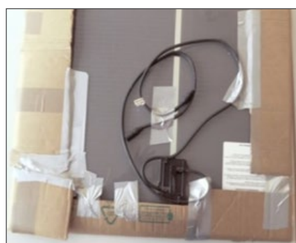
Bild 3 und 4: Sicherung eines ungerahmten PV-Moduls durch Pappe und Klebeband
