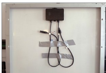
Bild 1 und Bild 2: Mit Klebeband fixierte Modulkabel
