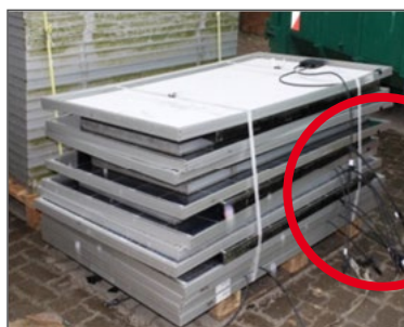
Bild 16: Mit Bändern auf Palette gesicherter Modulstapel [Foto: take-e-way GmbH]
